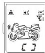
Zabezpečení mikrovlnným senzorem lze spustit stisknutím tlačítka ZAMKNOUT a ODEMKNOUT, což je potvrzeno rozsvícením symbolu „[ ]” na displeji dálkového ovládání. Pokud je zabezpečení mikrovlnným senzorem vypnuto, symbol „[ ]” na displeji nesvítí.
