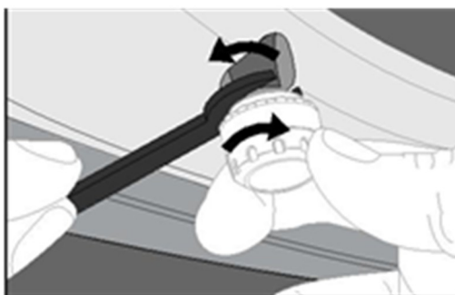
C. Našroubujte matici proti krádeži proti směru hodinových ručiček proti senzoru D. Utáhněte senzor a utáhněte matici proti krádeži proti směru hodinových ručiček pomocí klíče
