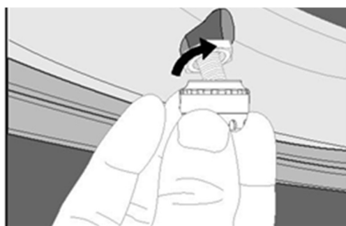
B. utáhněte snímač
