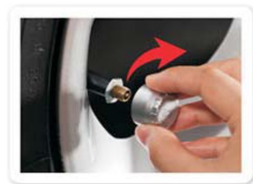
3. Našroubujte a dotáhněte správný senzor
