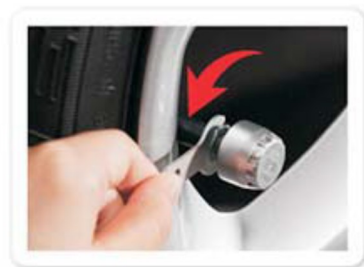
4. Pomocí klíče dotáhněte matici v opačném směru
