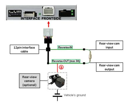
Die 12V Stromversorgung für die After-Market Rückfahrkamera (max. 3A) erfolgt durch Anschließen an die grüne Leitung des 12 Pin Interface Kabels um einen unnötigen Dauerbetrieb der Kameraelektronik zu vermeiden. Die beiden grünen Kabel "Reverse-IN" und "Reverse-OUT" müssen für den Betrieb miteinander verbunden bleiben.
