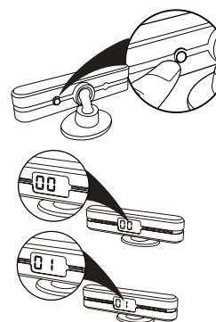
Stlačte tlačidlo na dve sekundy, uvoľnite a po jednej sekunde ho opäť stlačte pre zapnutie/vypnutie hlasovej signalizácie.
