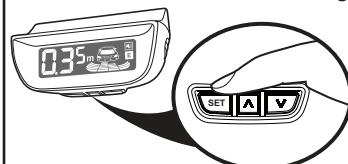
Pri zapnutom zapaľovaní zaraďte spiatočku. Stlačte jedenkrát tlačidlo SET pre zapnutie/vypnutie hlasovej signalizácie.
