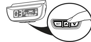
Tlačidlami „ $\wedge$ “ alebo „ $\vee$ “ nastavíte hlasitosť zvukovej signalizácie. Pokiaľ je vzdialenosť od prekážky menšia ako 0,3m, zvuková signalizácia sa automaticky nastaví na maximálnu hlasitosť. Od výroby je nastavená maximálna hlasitosť.
