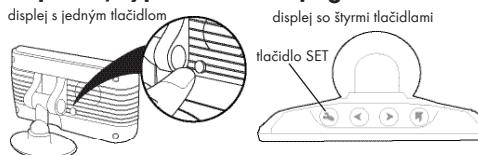
Pri zapnutom zapáľovaní zaradte spiatočku. Stlačte tlačidlo SET na dve sekundy, uvoľnite a po jednej sekunde ho opäť stlačte pre zapnutie/vypnutie hlasovej signalizácie.
