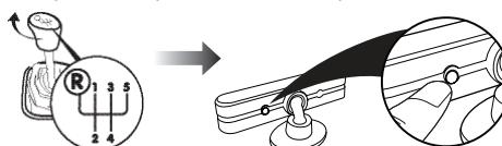
Tlačidlom SET nastavite hlasitosť zvukovej signalizácie. Pokiaľ je vzdialenosť od prekážky menšia ako 0,3m, zvuková signalizácia sa automaticky nastaví na maximálnu hlasitosť. Od výroby je nastavená maximálna hlasitosť.
